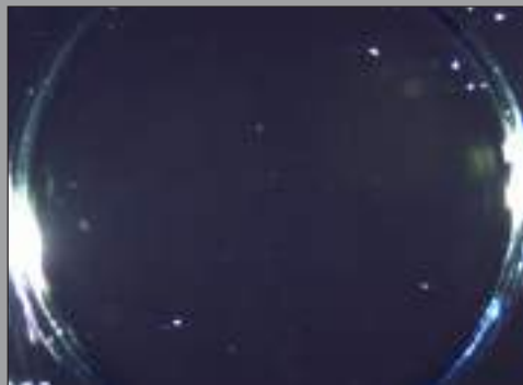
R1: La RayOne® Hydrophobic aparecen oscuras, con resultados medios de 1,96 \pm 3,69 MV/mm 2 y un valor de escala de Miyata de 0.
